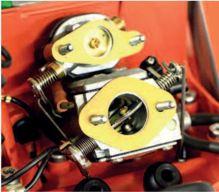
Zwei Venturi-Kanäle für den Vergaser weisen auf die Spülvorlagentechnik hin.
