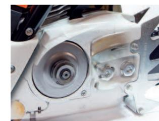
Innenliegende Kupplung und Power-Mate-Ritzel vereinfachen die Kettenmontage. Die verliersicheren Muttern sind allerdings nicht allerding nicht abmontierbar.
