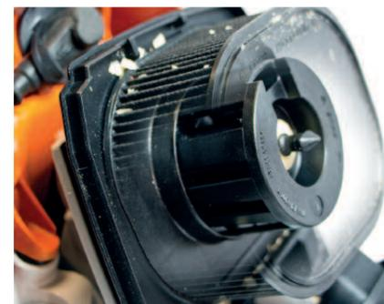
Der Luftfilter ist leicht auszubauen, aber schwer zu reinigen.
