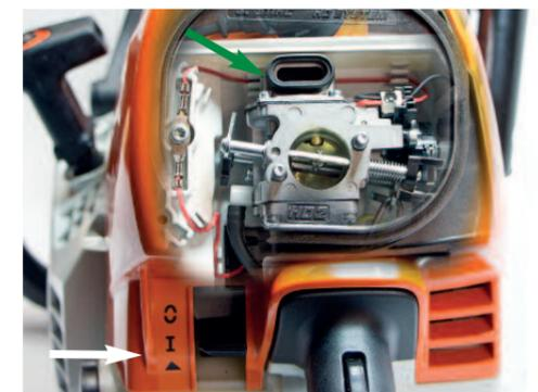
Der Vergaserraum wird durch den Luftfilter und die nachgelagerte Trennwand von Staub abgeschirmt. Der darunter liegende Membranvergaser übergibt, durch ein Magnetventil dosiert, den Kraftstoff an die Ansaugluft. Die Elektronik ermöglicht eine einfache Bedienung. Der Betriebsschalter (weißer Pfeil) kennt im Grunde nur zwei Positionen: Start und Stopp. Gut zu sehen ist der Kompensator (grüner Pfeil).
