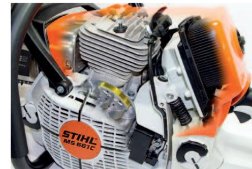
Das mikroprozessorgesteuerte Motormanagement M-Tronic wird durch ein zweites Magnetpaar (im Lüfterrad gelb hinterlegt) mit einem separaten Stromkreislauf versorgt. Es stellt alle drei Sekunden die Kraftstoffdosierung auf die aktuellen Betriebsbedingungen ein.
