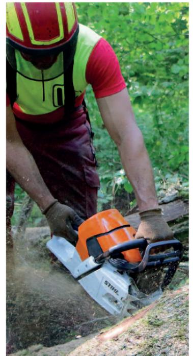
Beim Trennschnitt fliegen ordentlich Späne. Bei Starkholzfällung bewähren sich die 7,3 PS der 91-Kubikzentimeter-Hubraum-Säge und deren lange Führungsschiene. Fotos: Reetz
