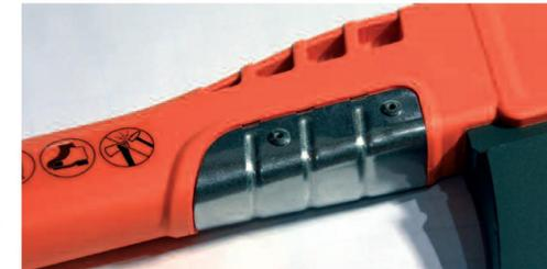
**Oben:** Die Achillesferse einer Axt mit Holzstiel liegt direkt unter dem Werkzeugkopf. Den robusten Kunststoffstiel der Axt bewahrt ein Edelstahl-Schlagschutz zusätzlich vor Schäden.
