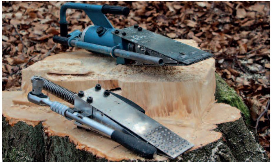
Im Größenvergleich fällt die kompakte Bauweise des TR 30 gegenüber einem hydraulischen Fällheber auf. Wichtig für die Profis: Das Werkzeug wiegt mit einem Gesamtgewicht von 5,4 Kilogramm nur ungefähr die Hälfte des ölbetriebenen Fällhebers. Für den Transport wird die Ratsche in eine Halterung geklemmt.
