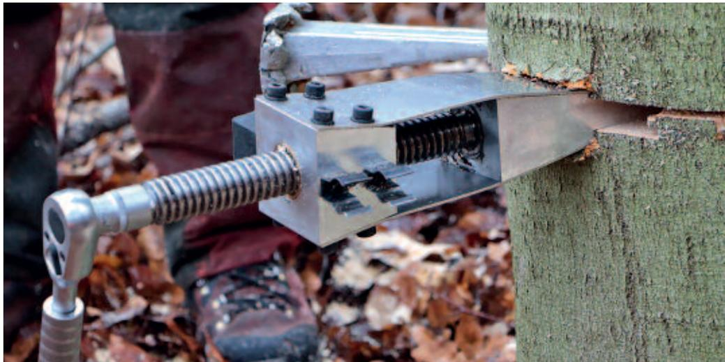
**Großes Foto links:** Der Fällschnitt wird gegenüber der Fallkerbe trichterförmig erweitert, so daß die beiden Federstahlplatten mit den Widerhaken vollständig in das Holz greifen.
